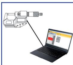
**УИС-СИСТЕМА ПЕРЕДАЧИ И ОБРАБОТКИ ДАННЫХ НА ПК**
