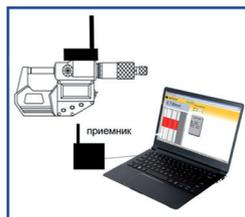
**БЕСПРОВОДНАЯ УИС-СИСТЕМА ПЕРЕДАЧИ И ОБРАБОТКИ ДАННЫХ НА ПК**
